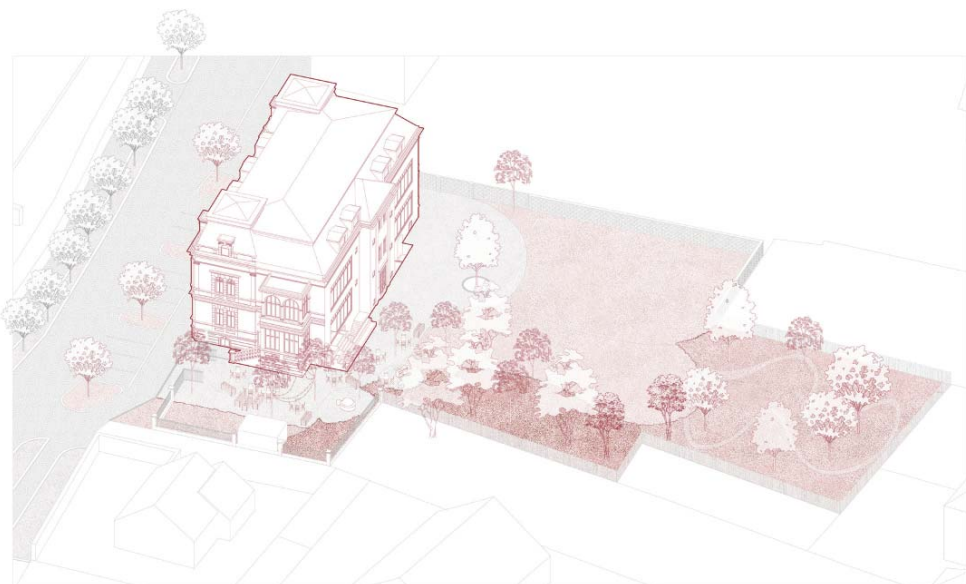
I. etapa - rekonstrukce vily, uličního předprostoru a zadní fasády; hrubé založení zahrady včetně zpevněných ploch
