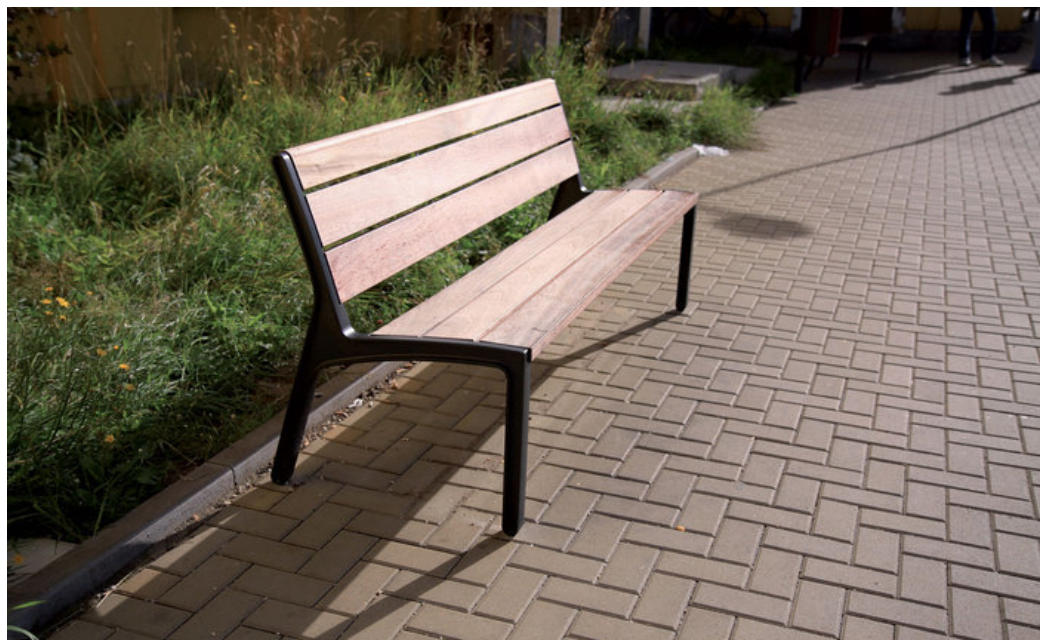
PŘÍKLADY VHODNÉHO SEDACÍHO MOBILIÁŘE – sedák a opěrák z tvrdého dřeva přírodního odstínu, kovová konstrukce (mm cité, typ Miela, Portiqoa)
