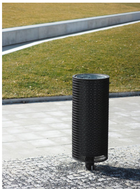
PŘÍKLADY MOBILIÁŘE – odpadkové koše při komunikacích s možností vjezdu údržby; materiálové řešení: dřevo, kov; masivní provedení s ohledem na trvanlivost a odolnost; některé odpadkové koše s popelníkem, sáčky pro psy
