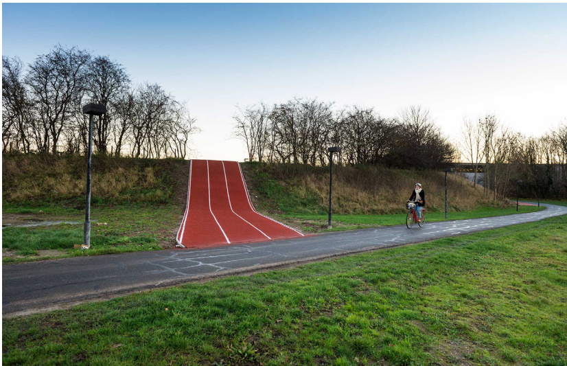
„BĚŽECKÁ DRÁHA” – základní kompoziční prvek spojující jednotlivé části Parku mladých; cesta široká 3,0 m s povrchem z probarveného asfaltu s originálními prvky „vodorovného značení”
