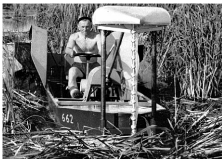
Žací lišta může sekát rákos až 1 m pod hladinou.
