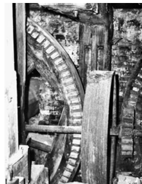
Převod vodního kola na mlýnské zařízení.
