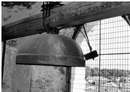
Hodinový stroj ovládá dva zvonové cimbály, jeden oznamuje čtvrtky a druhý celé hodiny.
