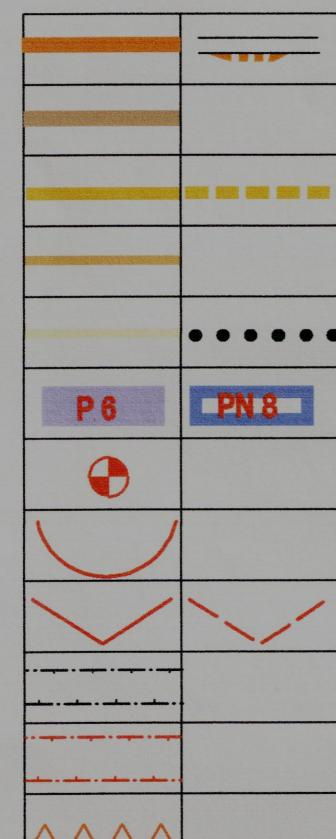
silnice II. třídy (funkce dopravně obslužná) / rozšíření pro zastávku autobusu
